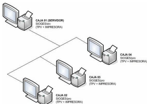
SIOGES/srv le permite actuar como un SIOGES/pro proporcionando, simultáneamente, un mecanismo para la centralización y compartición de la información de las unidades SIOGES/pro que se conecten a la red.
